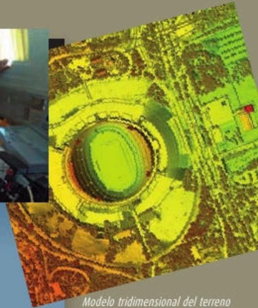
Modelo tridimensional del terreno obtenido desde una aeronave, por medio del láser.
